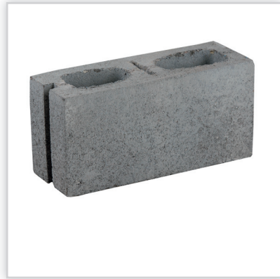
TeknoAmerBlok PK12. Pustak z betonu wibroprasowanego C30/37 o niespotykanej w tej klasie grubości ścian izolacyjności akustycznej R_w=50 dB i odporności ogniowej EI90 (dla ścian otynkowanych EI120). Umożliwia wykonywanie ścian działowych i wypełniających w budynkach mieszkalnych i biurowych, w pomieszczeniach gdzie wymagana jest wysoka izolacyjność akustyczna. Ekwiwalentny współczynnik przewodzenia ciepła: dla p=50\% \lambda_{10} , dry = 0,69 W/mK.
