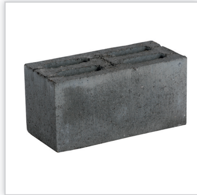
TeknoAmerBlok PK17,8AQ. Pustak z betonu wibroprasowanego C30/37 o niespotykanej w tej klasie grubości ścian izolacyjności akustycznej R_w=56 dB i odporności ogniowej REI120 (dla ścian otynkowanych REI180). Umożliwia wykonywanie ścian działowych, międzylokalowych, wypełniających a także nośnych w budynkach mieszkalnych i biurowych, w pomieszczeniach, gdzie wymagana jest wysoka izolacyjność akustyczna. Ekwiwalentny współczynnik przewodzenia ciepła: dla p=50\% \lambda_{10} , dry = 0,69 W/mK.
