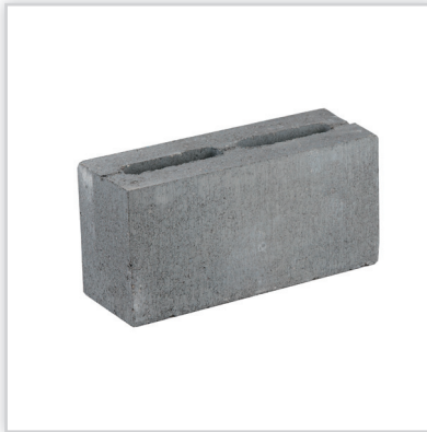
TeknoAmerBlok PK14 ogień. Pustak z betonu wibroprasowanego C30/37 o niespotykanej w tej klasie grubości ścian izolacyjności akustycznej R_w=50 dB i odporności ogniowej EI120 (dla ścian otynkowanych EI180). Umożliwia wykonywanie ścian działowych, wypełniających w budynkach mieszkalnych i biurowych, w pomieszczeniach, gdzie wymagana jest wysoka izolacyjność akustyczna. Ekwiwalentny współczynnik przewodzenia ciepła: dla p=50\% \lambda_{10} , dry = 0,82 W/mK.
