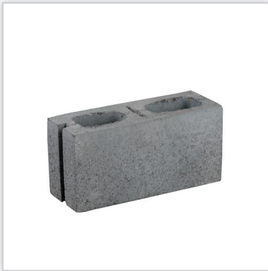
TeknoAmerBlok PK14. Pustak z betonu wibroprasowanego C30/37 o niespotykanej w tej klasie grubości ścian izolacyjności akustycznej R_w=50 dB i odporności ogniowej EI90 (dla ścian otynkowanych EI120). Umożliwia wykonywanie ścian działowych i wypełniających w budynkach mieszkalnych i biurowych, w pomieszczeniach, gdzie wymagana jest wysoka izolacyjność akustyczna. Ekwiwalentny współczynnik przewodzenia ciepła: dla p=50\% \lambda_{10} , dry = 0,69 W/mK.
