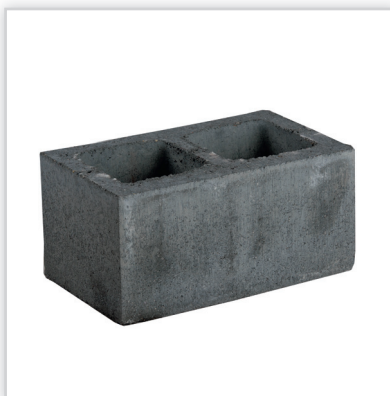
TeknoAmerBlok PK19AQ. Pustak z betonu wibroprasowanego C30/37 o niespotykanej w tej klasie grubości ścian izolacyjności akustycznej R_w=57 dB i odporności ogniowej REI120 (dla ścian otynkowanych REI180). Umożliwia wykonywanie ścian działowych, międzylokalowych, wypełniających a także nośnych w budynkach mieszkalnych i biurowych, w pomieszczeniach, gdzie wymagana jest wysoka izolacyjność akustyczna. Ekwiwalentny współczynnik przewodzenia ciepła: dla p=50\% \lambda_{10} , dry = 0,69 W/mK.
