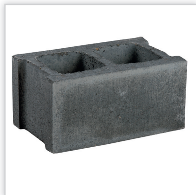
TeknoAmerBlok PK24. Pustak z betonu wibroprasowanego C30/37 o niespotykanej w tej klasie grubości ścian izolacyjności akustycznej R_w=56 dB i odporności ogniowej REI240 (dla ścian otynkowanych REI240). Umożliwia wykonywanie ścian działowych, międzylokalowych, wypełniających a także nośnych w budynkach mieszkalnych w pomieszczeniach, gdzie wymagana jest wysoka izolacyjność akustyczna. Ekwiwalentny współczynnik przewodzenia ciepła: dla p=50\% \lambda_{10} , dry = 0,69 W/mK.
