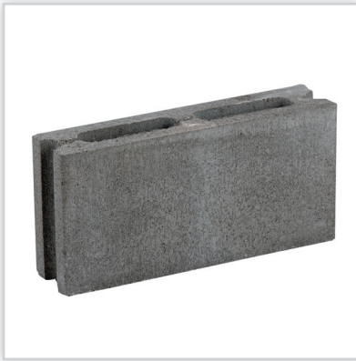
TeknoAmerBlok PK8. Pustak z betonu wibroprasowanego C30/37 o niespotykanej w tej klasie grubości ścian izolacyjności akustycznej R_w=48 dB i odporności ogniowej EI45 (dla ścian otynkowanych EI90). Umożliwia wykonywanie ścian działowych i wypełniających w budynkach mieszkalnych i biurowych, w pomieszczeniach, gdzie wymagana jest wysoka izolacyjność akustyczna, jak. Ekwiwalentny współczynnik przewodzenia ciepła: dla p=50\% \lambda_{10} , dry = 0,75 W/mK.
