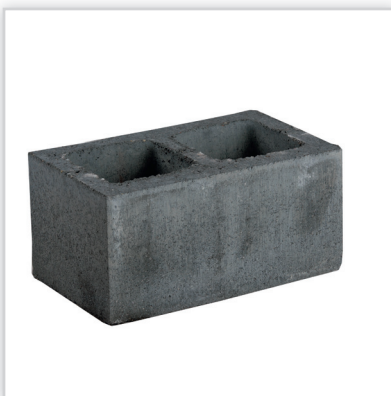
TeknoAmerBlok PK19. Pustak z betonu wibroprasowanego C30/37 o niespotykanej w tej klasie grubości ścian izolacyjności akustycznej R_w=55 dB i odporności ogniowej REI120 (dla ścian otynkowanych REI180). Umożliwia wykonywanie ścian działowych, międzylokalowych, wypełniających a także nośnych w budynkach mieszkalnych oraz biurowych, w pomieszczeniach, gdzie wymagana jest wysoka izolacyjność akustyczna. Ekwiwalentny współczynnik przewodzenia ciepła: dla p=50\% \lambda_{10} , dry = 0,69 W/mK.
