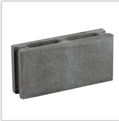
TeknoAmerBlok PK9. Pustak z betonu wibroprasowanego C30/37 o niespotykanej w tej klasie grubości ścian izolacyjności akustycznej R_w=49 dB i odporności ogniowej EI60 (dla ścian otynkowanych EI120). Umożliwia wykonywanie ścian działowych i wypełniających w budynkach mieszkalnych i biurowych, w pomieszczeniach, gdzie wymagana jest wysoka izolacyjność akustyczna. Ekwiwalentny współczynnik przewodzenia ciepła: dla p=50\% \lambda_{10} , dry = 0,69 W/mK.
